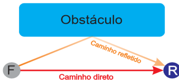
Figura 7 - Propagação do som entre uma fonte F e um receptor R, com reflexões de primeira ordem.
